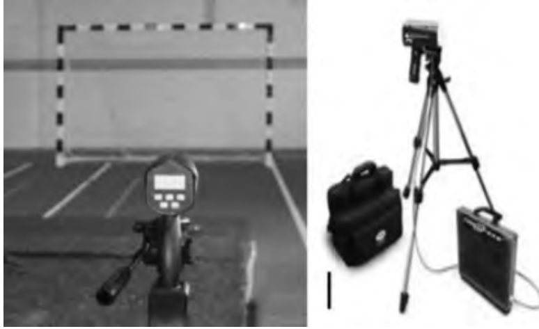
Resim 8.2 Kablosuz Fotosel Sistemi Smartspeed PT Modeli.
