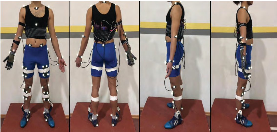
Resim 8.4 Hareket ve yürüyüş analiz sistemi ve işaretleyiciler (Marker).
