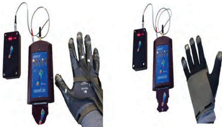
Resim 8.7 El basınç analizörü ve eldiveni.
