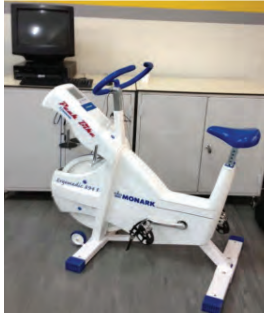
Resim 7.2 Wingate anaerobik bisiklet ergometresi.
