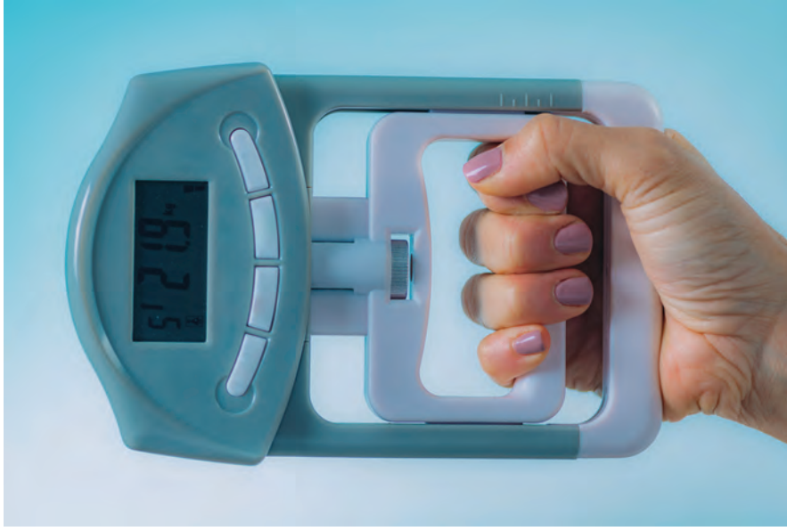
Resim 7.5 El kavrama kuvveti dinamometresi
