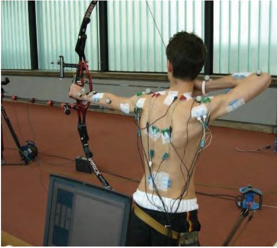
Resim 6.1 Okçuluk performansının yüzeyel Elektromiyografi kullanılarak değerlendirilmesi çalışmalarından bir örnek.
